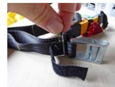
Extrayez tout le système de trims, coinceur compris (photo) et remplacez-le par la pièce de rechange dans l'ordre inverse. Veillez à remplacer l'aimant avec la bonne polarité, et sécurisez-le dans le rabat de la poche intérieure de sorte qu'il ne puisse pas tomber.
