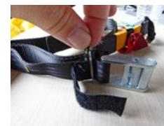
Bauen Sie das Gurtband mitsamt Schnalle (Bild) aus und ersetzen Sie es durch den Neuteil in umgekehrter Reihenfolge. Versichern Sie sich, dass der Magnet mit der richtigen Polarität und sicher im Einschubfach verstaut wurde und nicht herausfallen kann.
