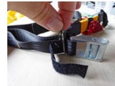
Vyjměte popruh s kameťem (viz obr.) a vyměňte ho za nový v opačném sledu. Ujistěte se, že jste magnet vrátili zpět do kapsičky na stejně místo správnou polaritou tak, aby nemohl vypadnout.
