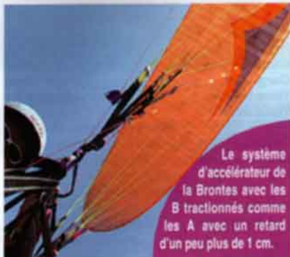
Un système efficace et désormais classique de tension du bord de fuite en plume à l'action à la commande.
