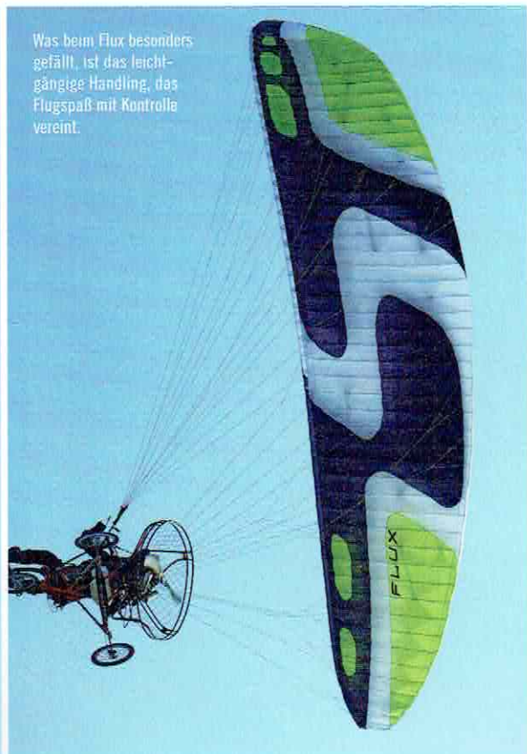
Der Flux neigt im Gegensatz zu anderen Reflexprofilen auch im beschleunigten Geradeausflug nicht zu unangenehmen Rollbewegungen um die Längsachse
