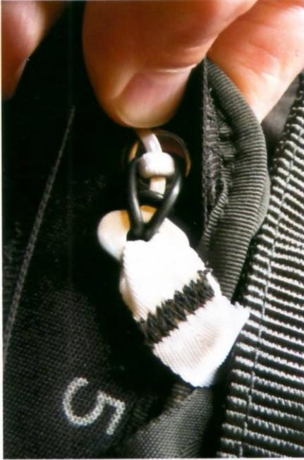
Un petit élastique astucieux permet d'empêcher le glissement de l'aiguille et l'ouverture intempestive sans gêner une ouverture décidée !
