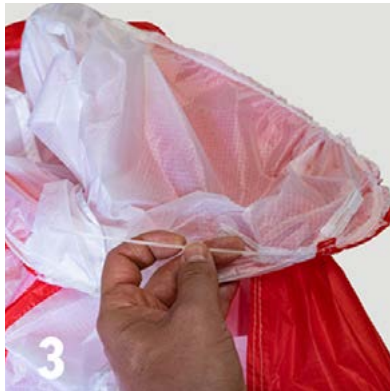
Und ziehen Sie ihn heraus. Vergleichen Sie den alten Stab mit dem neuen Material und schneiden Sie dieses auf die korrekte Länge zu. Setzen Sie das neue Stück in die Tasche ein und achten Sie darauf, beide Enden des Stabs vollständig in den kleinen Taschen an beiden Enden zu verankern. Foto 3.
