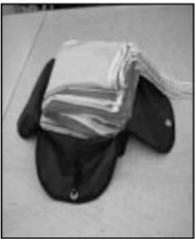
Složený vrchlík vložte do vnitřního kontejneru.
