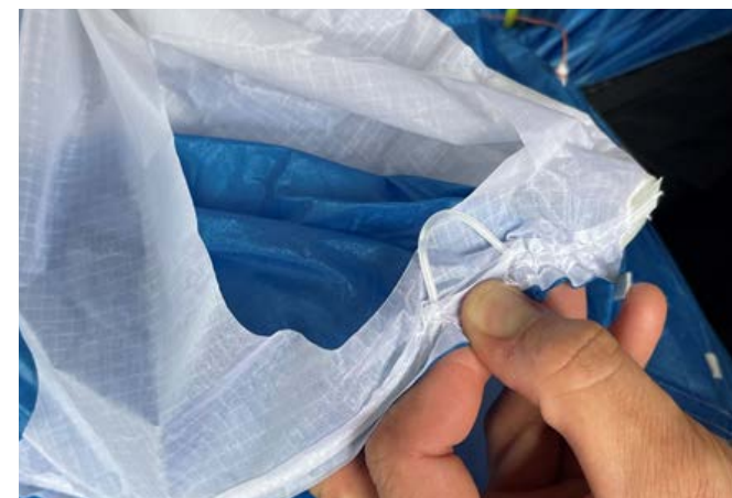
Heben Sie die Nylonstab aus der Tasche am Untersegel. Foto 2. Und ziehen Sie ihn heraus. Vergleichen Sie den alten Stab mit dem neuen Material und schneiden Sie dieses auf die korrekte Länge zu. Setzen Sie das neue Stück in die Tasche ein und achten Sie darauf, beide Enden des Stabs vollständig in den kleinen Taschen an beiden Enden zu verankern.
