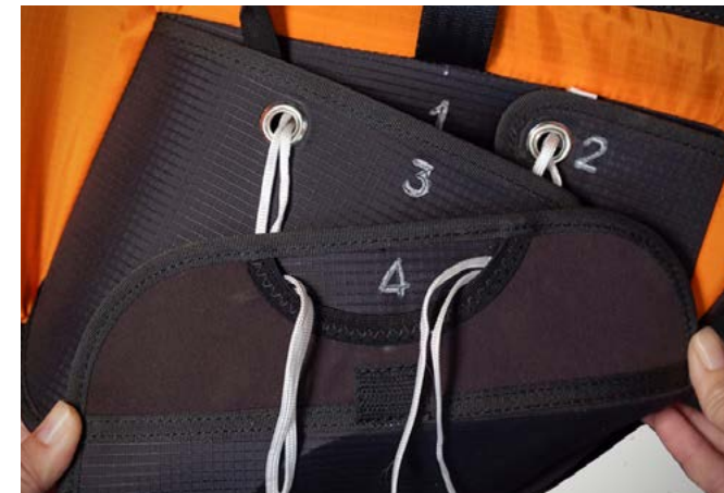
3) Šňůrky, které naleznete v kapsičce zádové kapsy sedačky, provlečte gumovými očky kontejneru a postupně uzavřete chlopně dle naznačeného pořadí.
