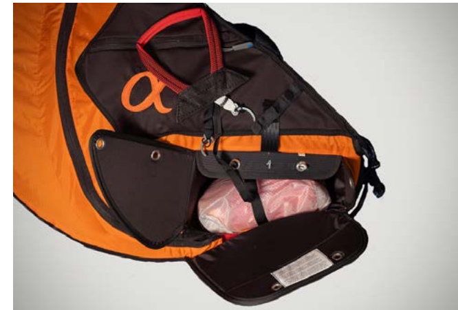
2) Připevněte kliku k středovému poutku vnitřního kontejneru záložního padáku. Přehněte záložní padák na polovinu a vložte do integrovaného kontejneru sedačky, přičemž klika směřuje ven.
